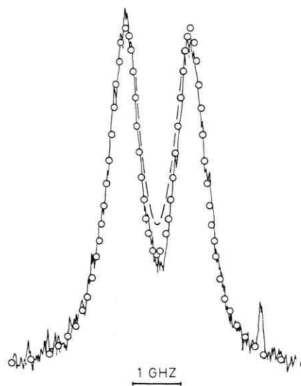
Abb. 7. Ausschnitt aus einem experimentellen Streulichtspektrum bei einem Druck von 125 bar. \circ\circ\circ : Theoretisches Spektrum für eine Relaxationszeit \tau_V = 70\text{ psec} mit \eta_{V,\infty} = \eta_s . --- : Teil eines theoretischen Spektrums mit \tau_V = 62,5\text{ psec} .
